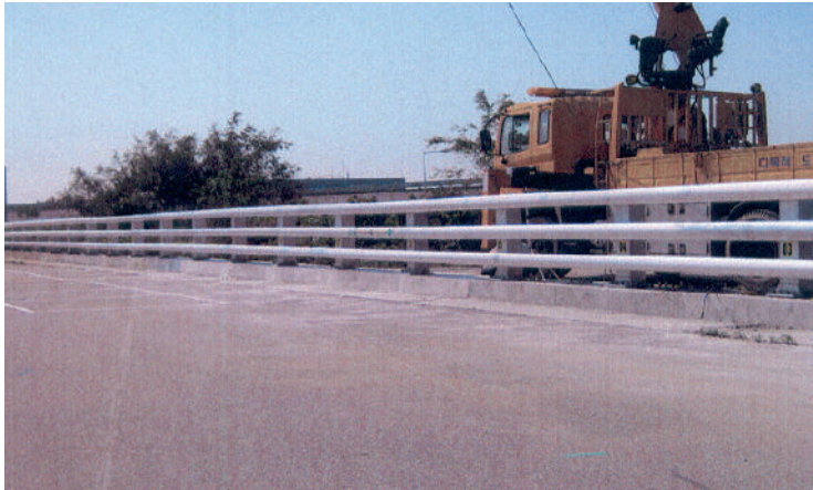
▼트럭시험 - 시험 전 시험품
